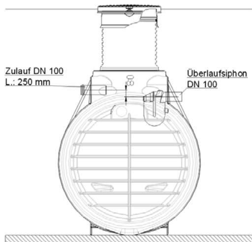
Jetzt den vorbereiteten SUPRA®-Filter Intern in den Tank einsetzen, der Bogen am Überlauf des Filters wird dabei in den Überlausiphon gesteckt. Das Zulaufrohr wird so ausgerichtet, dass es bündig mit dem Filterzulauf abschließt und anschließend mit der Schnellmontage-Manschette fixiert.
