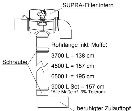
Anschließend werden am Zulauf und Überlauf des Erdtanks Columbus ein 250 mm langes Zulaufrohr sowie der Überlausiphon, wie in der nebenstehenden Abbildung gezeigt, bis zum Anschlag eingeschoben.
