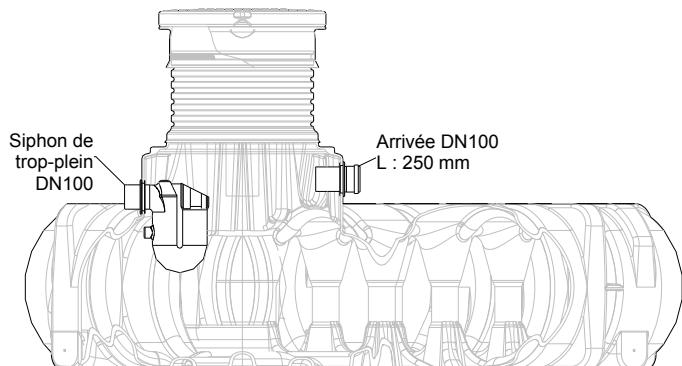
Insérer le filtre SUPRA interne dans la cuve, et insérer le trop-plein du filtre dans le coude du siphon de trop-plein. Insérer ensuite le tuyau d'arrivée jusqu'à ce qu'il soit en bout à bout avec l'entrée du filtre, puis fixer à l'aide de la manchette de fixation rapide.
