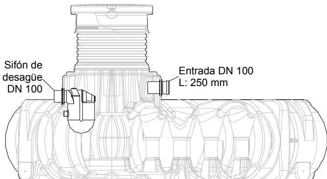
Ahora colocar en el tanque el filtro SUPRA filtro interno preparado, para ello se inserta el codo en el desagüe del filtro en el sifón de desagüe. El tubo de alimentación es ajustado de manera tal, que cierra a ras con la alimentación de filtro y a continuación se fija con el manguito de montaje rápido.
