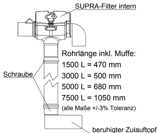
Anschließend werden am Zulauf und Überlauf des Li-Lo Flachtanks ein 250 mm langes Zulaufrohr sowie der Überlauspsiphon, wie in der nebenstehenden Abbildung gezeigt, bis zum Anschlag eingeschoben.
