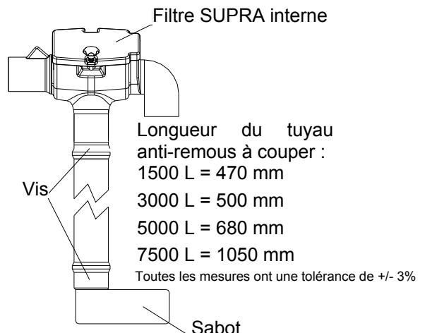
Ensuite, insérer le manchon lg. 250 mm (joint à lèvres à l'ext. de la cuve) dans l'entrée de la cuve Li-Lo et insérer le siphon dans la sortie de cuve, comme le montre le schéma ci-contre.
