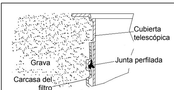
**Atención:** Una vez que se seca el jabón blando es muy difícil mover el telescopio y se corre el riesgo de que la junta se resbale de la ranura. Antes de tapar corroborar la posición correcta de la junta. El telescopio debe tener suficiente relleno interior de manera que las fuerzas no repercutan de ninguna manera sobre la carcasa.
