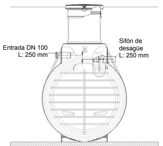
Ahora colocar en el tanque el filtro SUPRA filtro interno preparado, para ello se inserta el codo en el desagüe del filtro en el sifón de desagüe. El tubo de alimentación es ajustado de manera tal, que cierra a ras con la alimentación de filtro y a continuación se fija con el manguito de montaje rápido.
