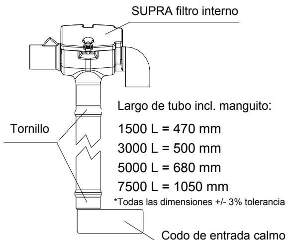
A continuación en la entrada y el desagüe del tanque subterráneo se inserta, hasta que haga tope, un tubo de alimentación de 250 mm así como un sifón de desagüe, como se muestra en la figura de al lado.
