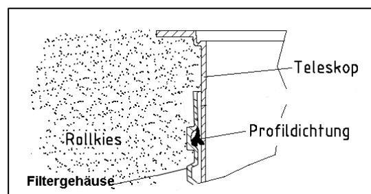
**Achtung:** Trocknet die Schmierseife an lässt sich das Teleskop nur noch sehr schwer bewegen und es besteht die Gefahr, dass die Dichtung aus der Dichtnut rutscht. Vor dem Verfüllen muss die Dichtung auf ihren korrekten Sitz überprüft werden. Das Teleskop muss ausreichend unterfüttert werden, so dass sich Kräfte auf keinen Fall auf das Gehäuse übertragen können.
