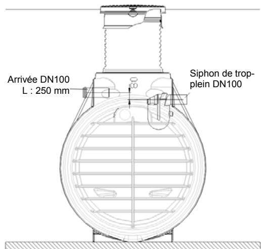
Insérer le filtre SUPRA interne dans la cuve, et insérer le trop-plein du filtre dans le coude du siphon de trop-plein. Insérer ensuite le tuyau d'arrivée jusqu'à ce qu'il soit en bout à bout avec l'entrée du filtre, puis fixer à l'aide de la manchette de fixation rapide.
