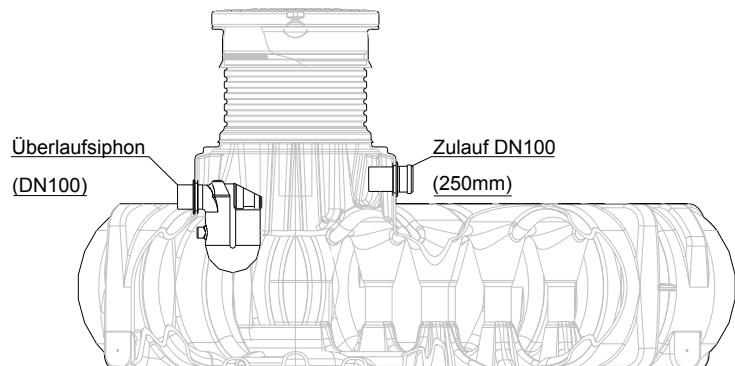
Jetzt den vorbereiteten SUPRA®-Filter intern in den Tank einsetzen, der Bogen am Überlauf des Filters wird dabei in den Überlauspsiphon gesteckt. Das Zulaufrohr wird so ausgerichtet, dass es bündig mit dem Filterzulauf abschließt und anschließend mit der Schnellmontage-Manschette fixiert.
