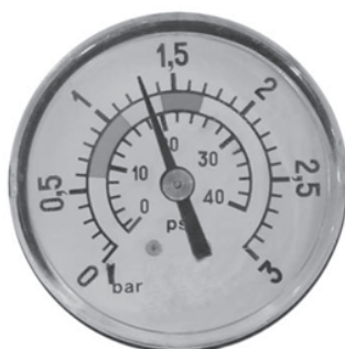
1,3 kg/cm 2 - 18,5 PSI: Esta pressão indica que é necessário proceder à lavagem "Lavado".
