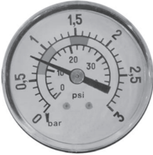
0,8 kg/cm 2 - 11,4 PSI: filitreleme sürecinin başındaki normal basınç
