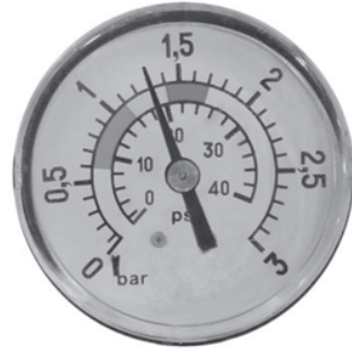
1,3 kg/cm 2 - 18,5 PSI: Cette pression indique qu'il est nécessaire de procéder à un LAVAGE.
