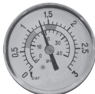
1,3 kg/cm 2 - 18,5 PSI: Dieser Druck zeigt an, dass ein "SPÜLEN" notwendig ist.
