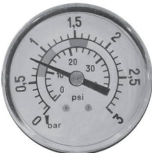
0,8 kg/cm 2 - 11,4 PSI: Normaldruck bei Beginn des Filtriervorganges.
